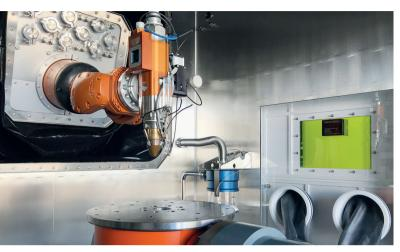
**Schutzgaszelle:** Dank der Nutzung eines fasergeführten Systems kann der Kuka-Roboter nahezu uneingeschränkt arbeiten und auch komplexe Geometrien realisieren © Kuka
